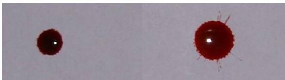
Obr. 4 Tvar kapky po dopadu: vlevo – dopad z výšky 10 cm, vpravo – z výšky 2 m
